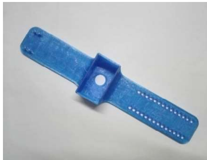
Fig. 8. Pulsera contenedora de sistema medidor de señales biomédicas, el cual se coloca en la caja central.
